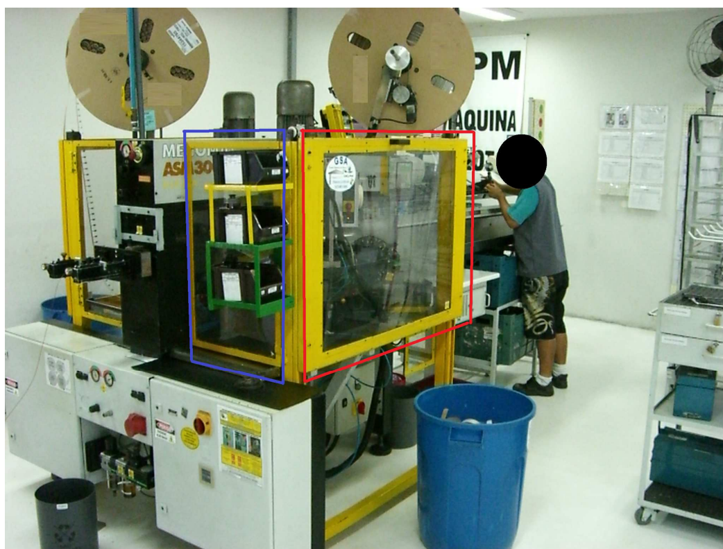
Figura 31 – Nova proteção móvel do lado direito da Megomat 3001 (destaque em vermelho) e proteção fixa (em azul)
