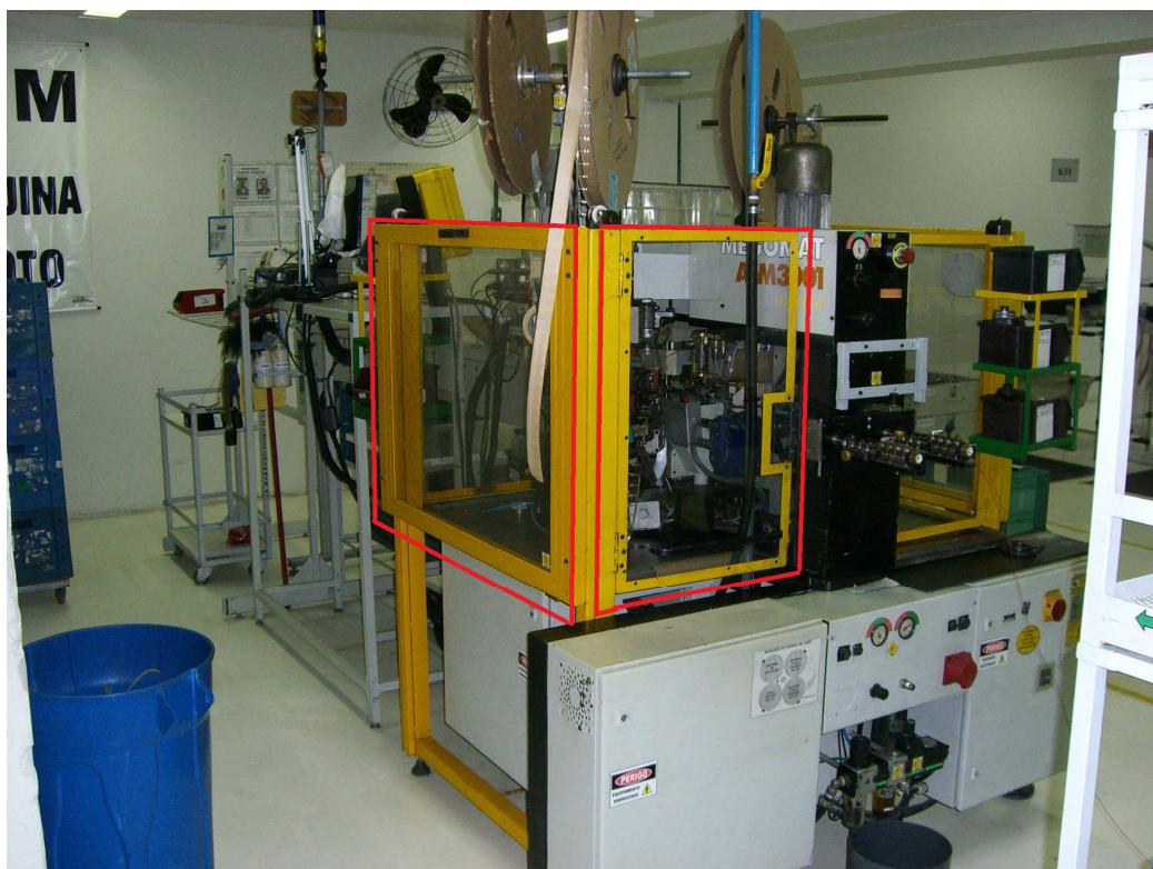
Figura 32 – Novas proteções móveis dos lados esquerdo e posterior da Megomat 3001 (destacadas em vermelho) Fonte: Arquivo pessoal, 2011
