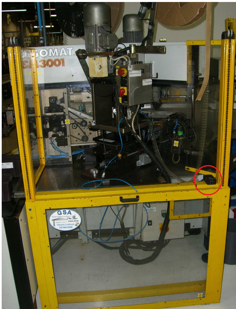
Figura 34 – Proteção móvel da Megomat 3001 na posição aberta com destaque para a chave de segurança eletromecânica (em vermelho) Fonte: Arquivo pessoal, 2011
