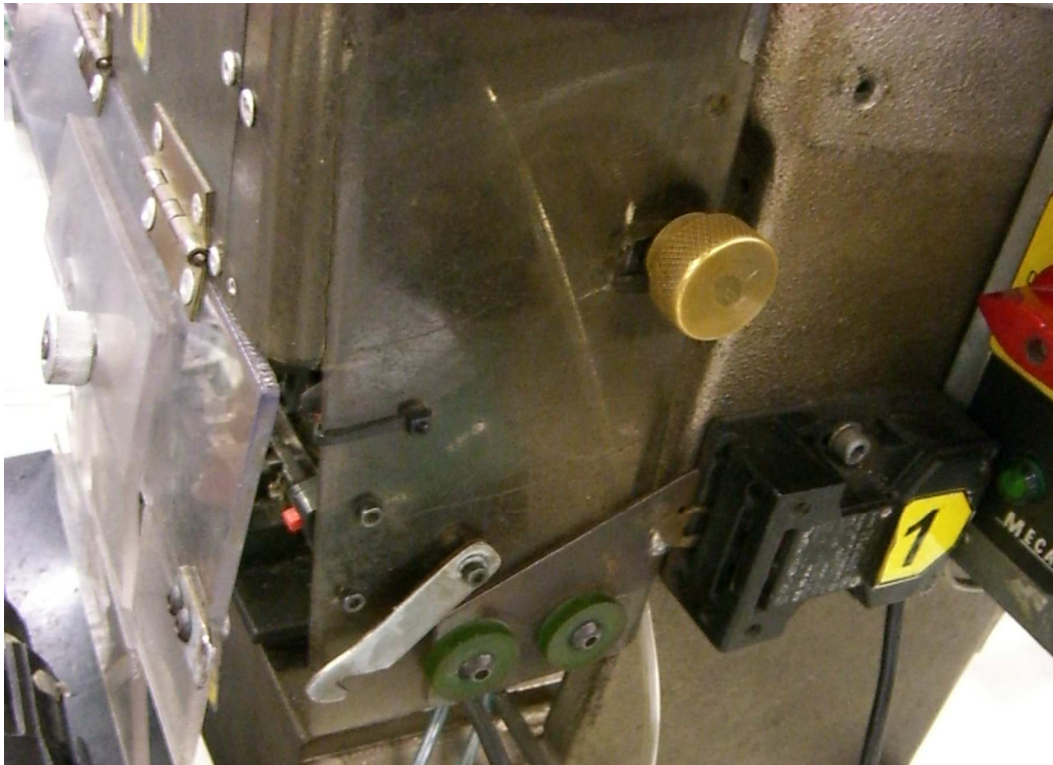
Figura 18 – Segunda proteção móvel frontal da Mecal P-107 com chave eletromecânica sem duplo canal e sem monitoramento por interface de segurança Fonte: Arquivo pessoal, 2011
