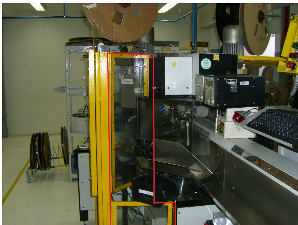
Figura 33 – Nova proteção fixa do lado frontal da Megomat 3001 (destacada em vermelho) Fonte: Arquivo pessoal, 2011
