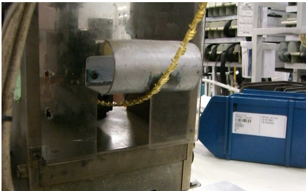
Figura 19 – Proteção posterior da Mecal P-107 sem dispositivo de intertravamento associado Fonte: Arquivo pessoal, 2011
